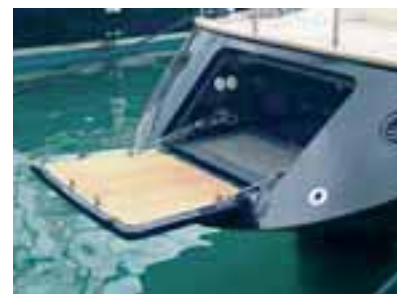
Il portellone dello specchio di poppa, è un pò troppo visibile quando chiuso, ma in posizione aperta, rivela un'ampia spiaggia dotata di doccia
