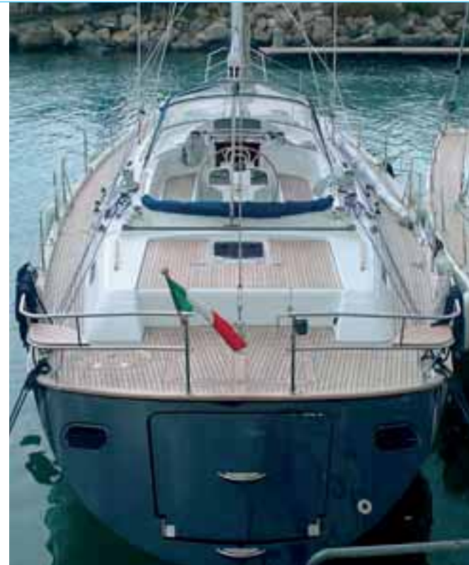
Il portellone dello specchio di poppa, è un pò troppo visibile quando chiuso, ma in posizione aperta, rivela un'ampia spiaggia dotata di doccia
