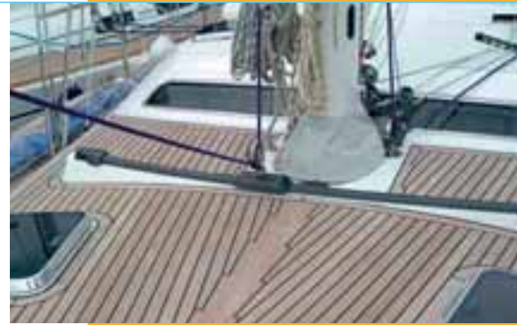
La trinchetta autovirante rende la gestione della barche molto più semplice e poco faticosa
